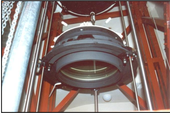
Objektiv und Gittertubus des Teleskops
